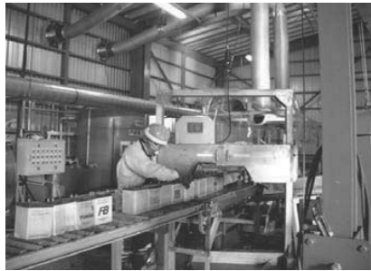
廃バッテリー解体
