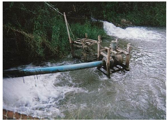
Pheeddarkat Canalの落差工に設置された小水力発電機
