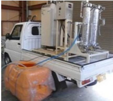
ODA 事業で供与を想定する移動式排水処理車両。装置ユニットは脱着可能。(イメージ)
