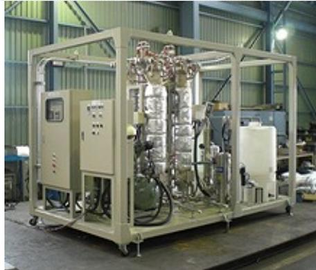
ODA 事業でトラックに搭載を想定しているJトップ社排水処理装置の大型デモ機 (イメージ)
