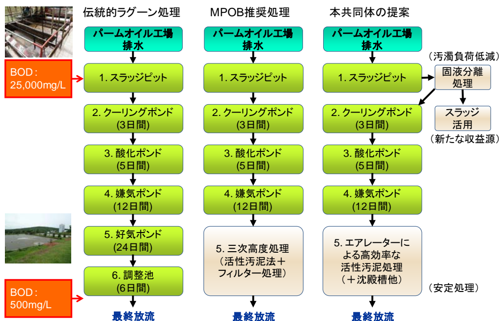
図 20 伝統的処理、MPOB 推奨モデル、本共同体の提案の比較
