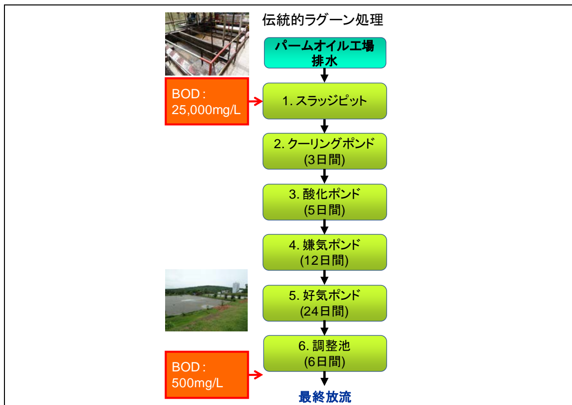
図 7 現状のパームオイル工場排水の処理フロー（フロー事例として POMTEC）
