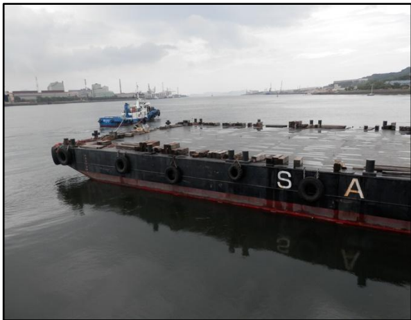
台船（タグボートにて台船を曳航）
