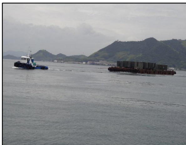
船体ブロック（1000t）を台船に積載し曳航中
