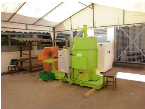
写真1： タンザニアに持ち込んだもみ殻固形燃料 製造装置
