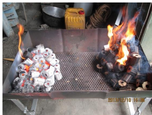
写真 18 : もみ殻固形燃料が燃える様子
