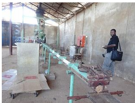
写真 3-6 インド製の固形燃料製造装置
