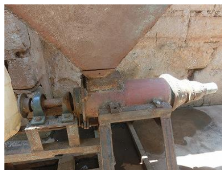
写真 2-10 エンマン社の木屑固形 燃料製造装置 (未完成品)
