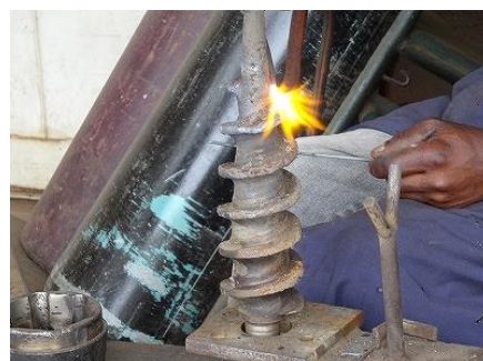
写真 2-4 KIDT で製造したスクリューをメンテナンスする様子
