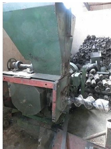
写真 3-12 中国製（2004 年製）の固形燃料製造装置
