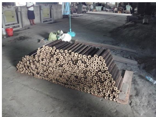
写真 17 : 調査団が現地で製造したもみ殻固形燃料
