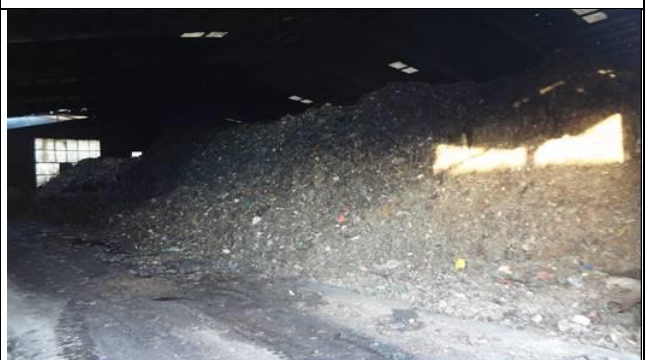
ドンナイ省のコンポスト化施設。キルンで高速堆肥化が施されたのちここで30日エイジングされる。
