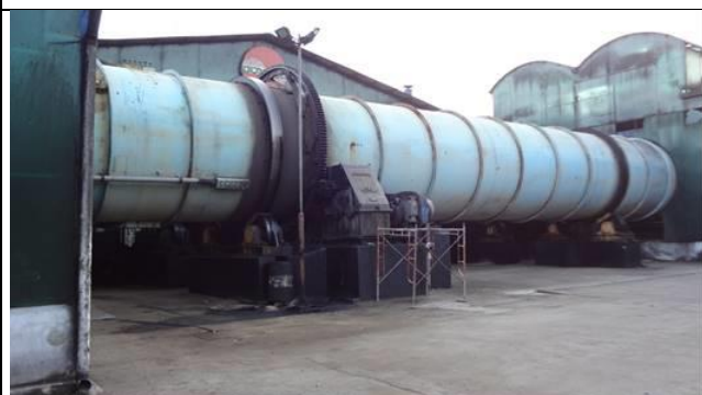
ドンナイ省のコンポスト化施設。都市ごみはまずこのキルンで攪拌されながら、18時間、高速堆肥化される。
