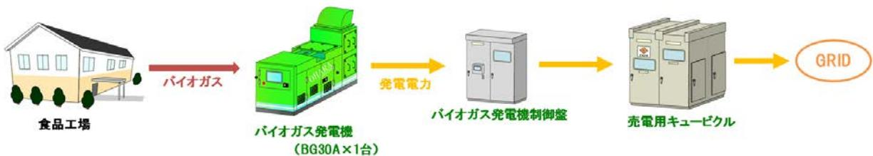
図 2-3 食品工場排水由来バイオガスへの導入事例
