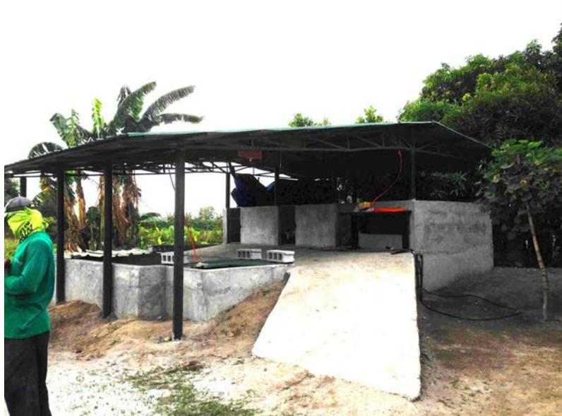
写真 3-2 バイオガス醗酵試験装置
