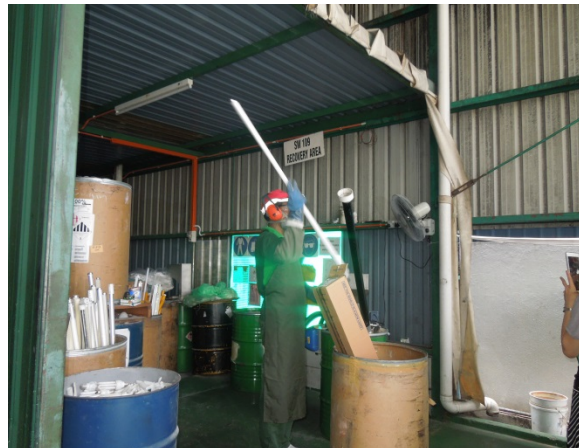
民間提案型普及・実証事業実施候補地の視察情景 (3)_ TexCycle Technology社フルリカバリー施設: 廃 蛍光灯処理実演中の情景。破碎物はクアリティ・アラム 社へ運搬される。同社のみが、SW109(廃蛍光灯 が該当すると考えられる指定廃棄物コード)を処理す るライセンスを取得し、蛍光灯を受け入れている。す べての形状の蛍光灯を受け入れている。
