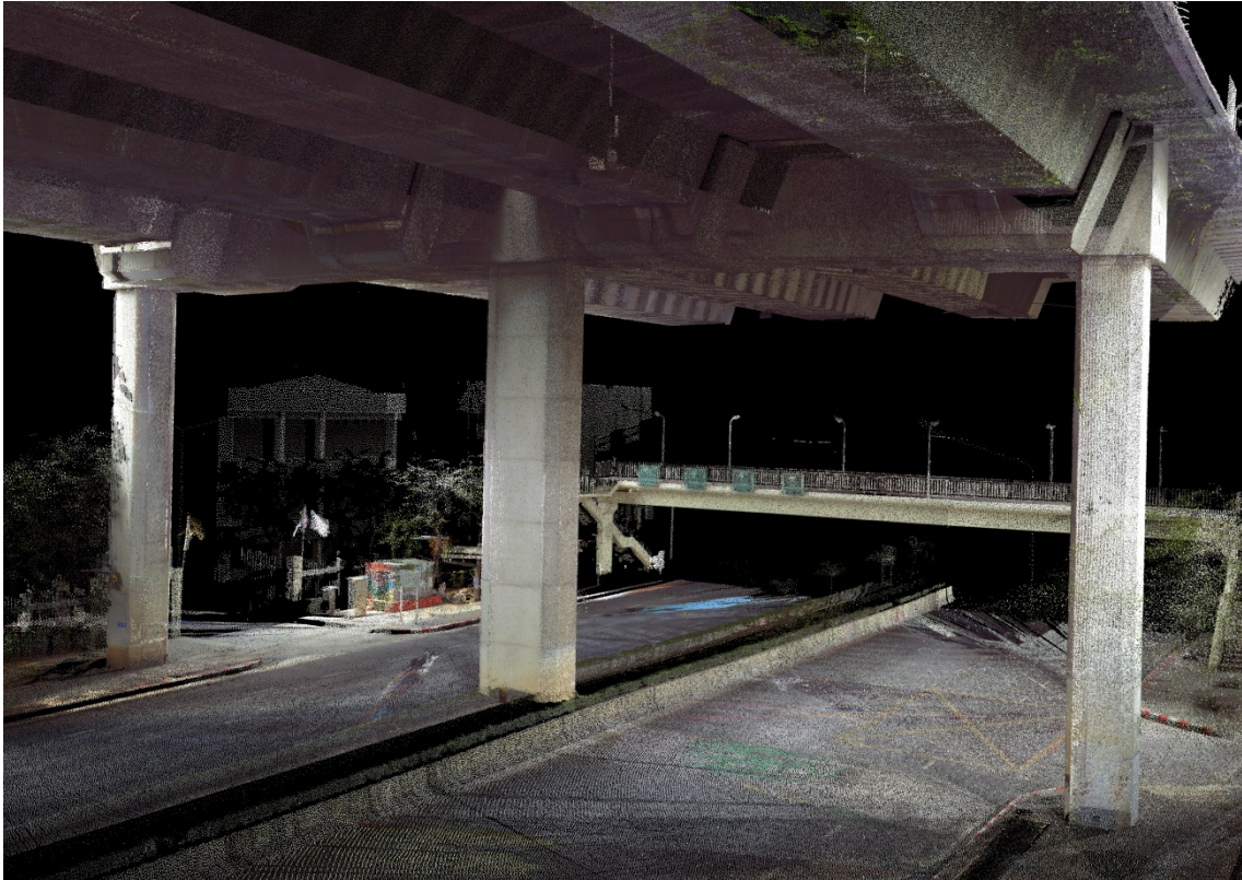
<図 3-15>DOH 橋脚の 3D レーザースキャナによる計測結果
