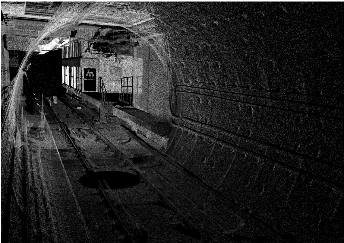
<図 3-10> MRTA 地下鉄トンネルの 3D レーザースキャナによる計測結果
