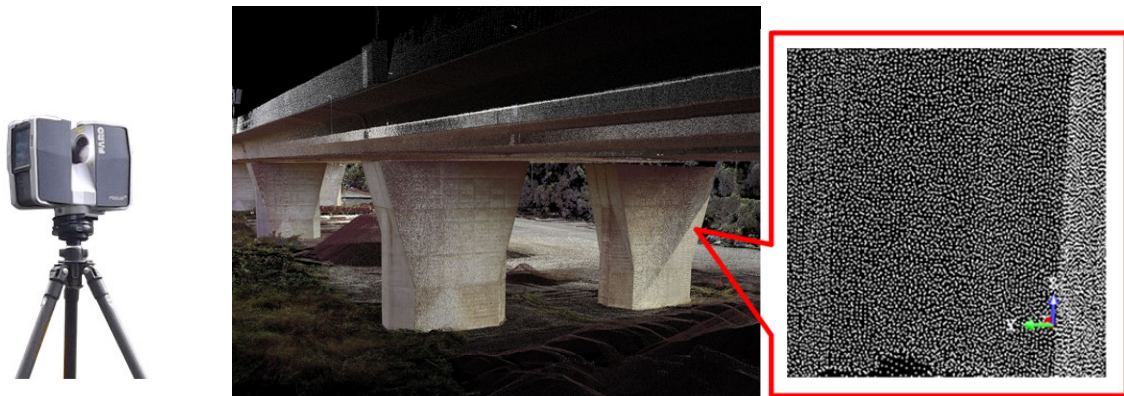
<図 2-9>3D レーザースキャナ（FARO 社製）と計測データサンプル
