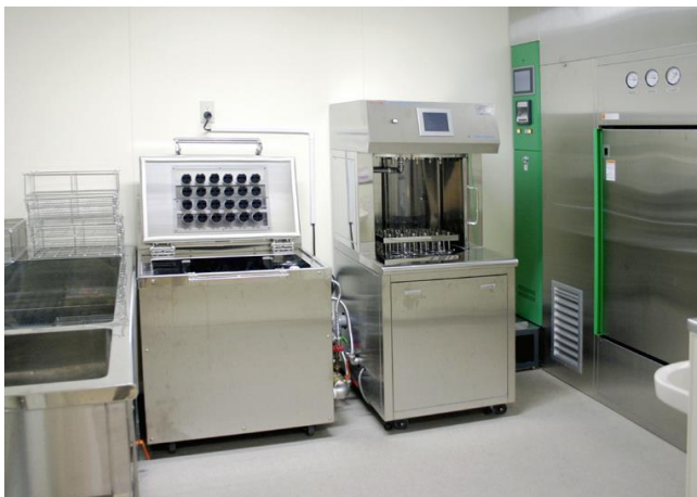
日本の調乳設備 (左から 予浸槽、ブラシ洗浄機、すすぎ洗浄機、 高圧蒸気滅菌機 )
