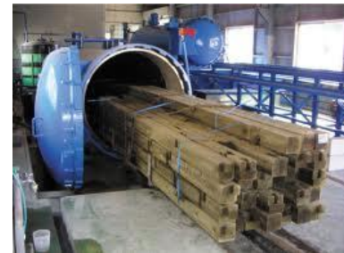
図 3-21 加圧注入設備
