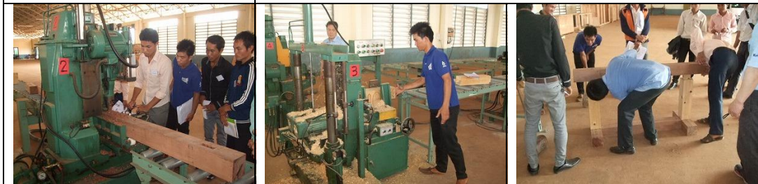
11. 受講生によるプレカット加工・作業台の組み立て
