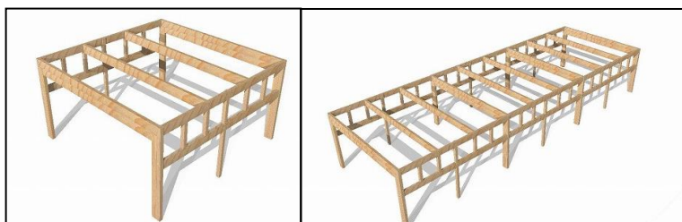
図 2-4 住宅用フレーム 左：単体フレーム 右：連続フレーム
