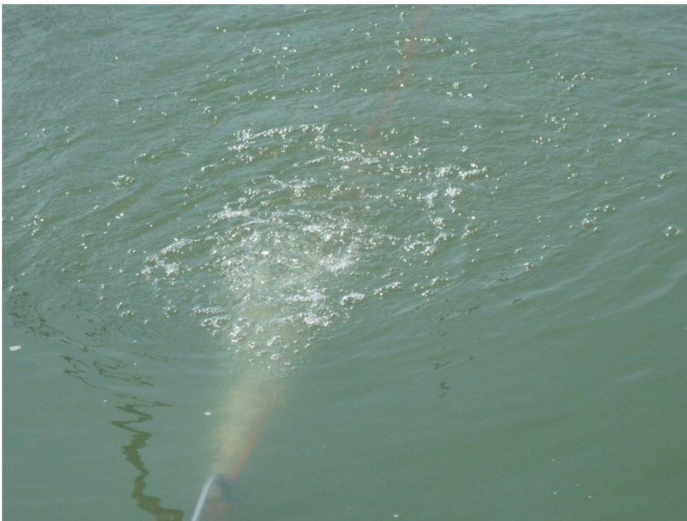
システム稼働実験（発電を行ってバブルを噴射している様子）
