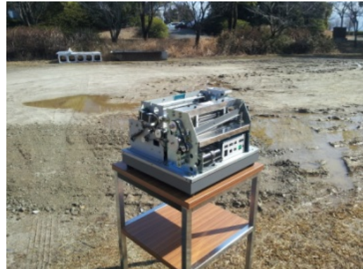
図 2-9 カバー装着、砂、ほこりなどの付着状況調査—熊本支社・工場
