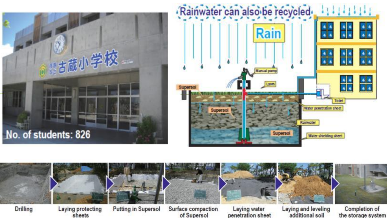
図 6 スーパーソルを用いた雨水貯留槽
