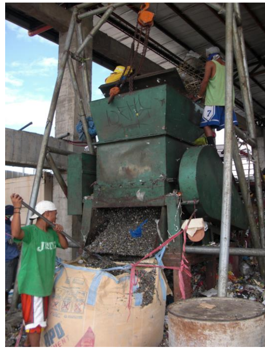
CMSI の MRF Plant の フラフ燃料製造用粉碎機
