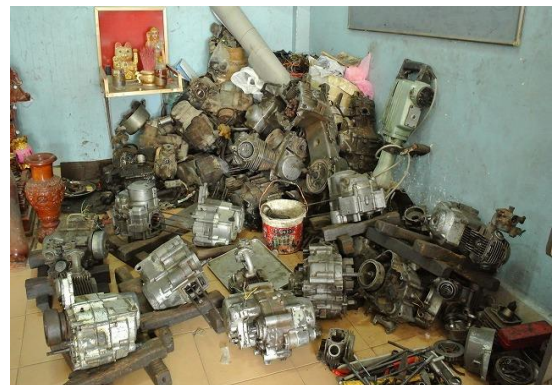
民間職業訓練校の自動車整備技術訓練で使用されているエンジン
