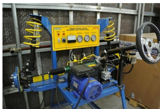
図 35 職業訓練校で使用されている自動車整備の訓練機材
