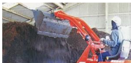
図 29 小型乗用ローダー （山陽機器製）
