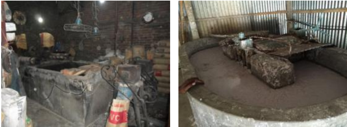
図 2-3 ポリ袋をチップにする装置（左）、紙を溶かしてリサイクルする装置（右）
