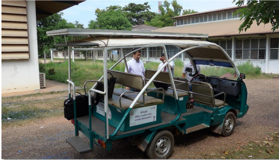
図 3-3-2 ラオス国立大学が製作したコンバージョン EV
